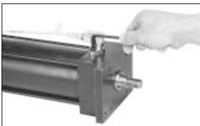
Visser le capteur dans le vérin.
